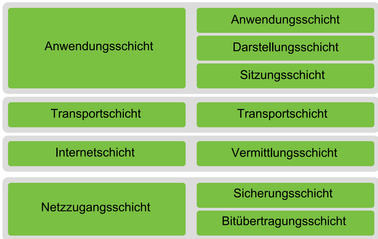
ABBILDUNG 20.1 VEREINFACHTES SCHICHTMODELL FÜR TCP/IP
