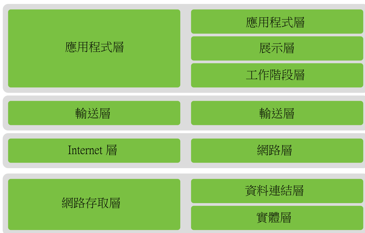
圖形 20.1 TCP/IP 的簡化層模型
